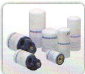
Filtri per compressori Compressor filters Cartucce avvitabili per la separazione aria-olio idonee per compressori rotativi a vite o a palette. Air/oil separator elements using the coalescence principle. Easily installed an replaced, suitable for rotary or piston compressors.
