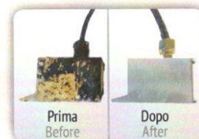
Rigenerazioni parti riscaldanti Regeneration heating elements
